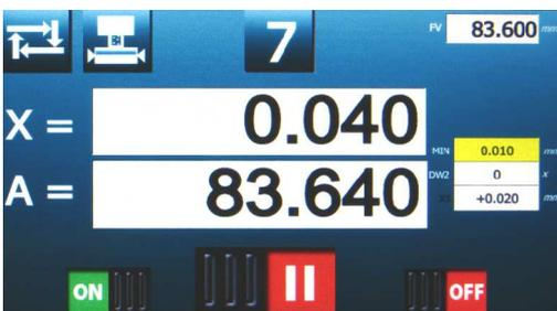
Nach der Umschaltung in den automatischen Betrieb mit der Taste **F2** drückt man die Taste **F8**. Der Schleifspindelstock wird in die Ausgangsposition für das Schleifen versetzt. Mit dem Handhebel wird der Schleifvorgang gestartet. Beim Schleifen kann man mit den Tasten links und rechts unten die Zugabe in Wendepunkten ausschalten.
